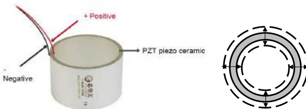
Рисунок 3.2.2 – Излучающий элемент – пьезоэлектрический полый цилиндр с радиальной поляризацией. Справа – демонстрация его радиальных колебаний
