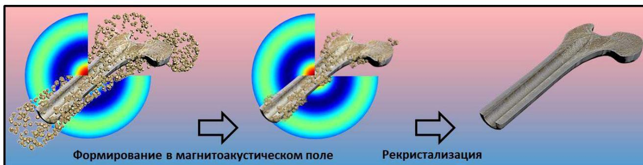
Рисунок 4.1.6 – Схематическое изображение изготовления трехмерного каркаса с использованием магнитоакустического поля, включая сборку и перекристаллизацию скаффолда [147]
