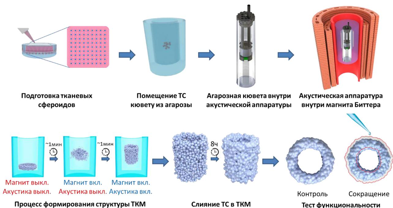
Рисунок 4.2.14 – Схема эксперимента по левитационной магнитоакустическому формированию трубчатому ТКМ [83]
