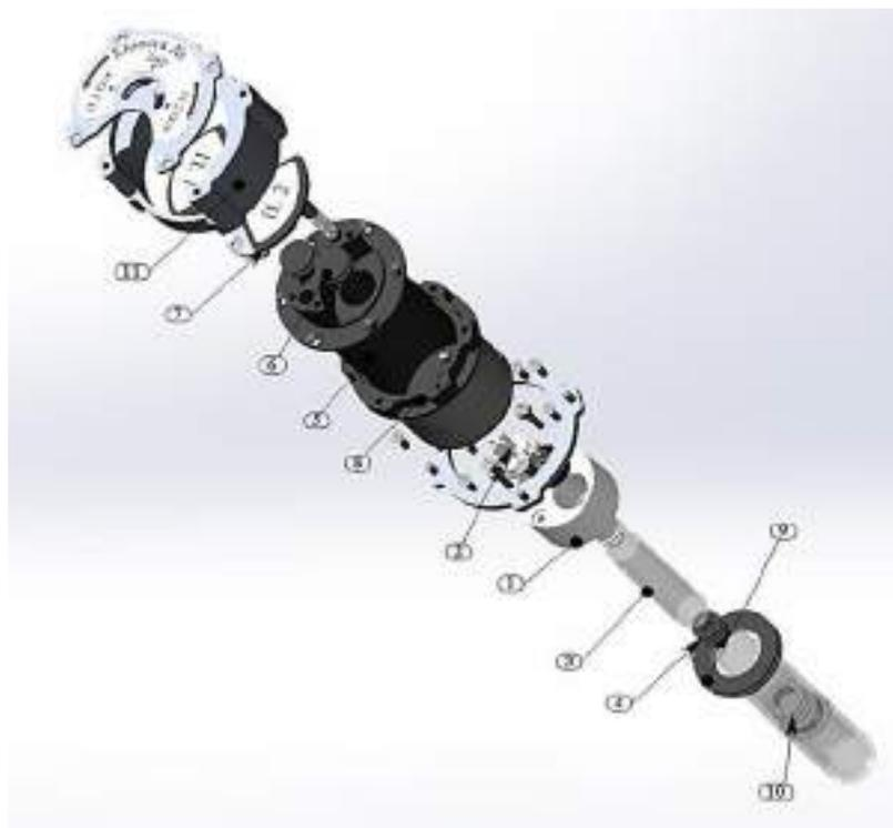
Рисунок 5.1.9 - Кювета, использованная в эксперименте: 1 - внутренний сосуд; 2 - поршни; 3 - внутренняя трубка; 4 - компенсатор; 5 - внешний корпус; 6 - защитные поршни; 7 - поршни; 8 - защитный скаффолд; 9 - внешняя трубка; 10 - компенсатор; 11 – фиксатор [196]
