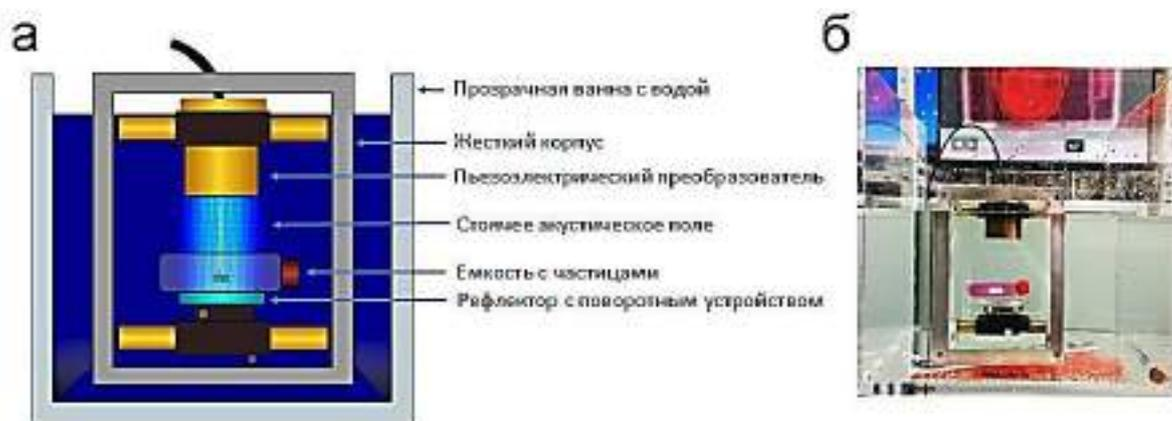
Рисунок 4.4.2 – Акустическая установка: а) схема экспериментальной установки; б) фотография экспериментальной установки
